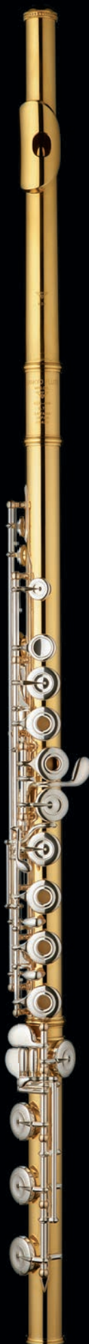
24K Gold mit Silberklappen 24K Gold Kopfstück, Korpus, Fußstück, Ringe, 14K Gold Säulchen und Platten, Silber Klappen. 10K Weißgold-Federn. Gelötete Tonlochkammine. Wandstärke 0,30
